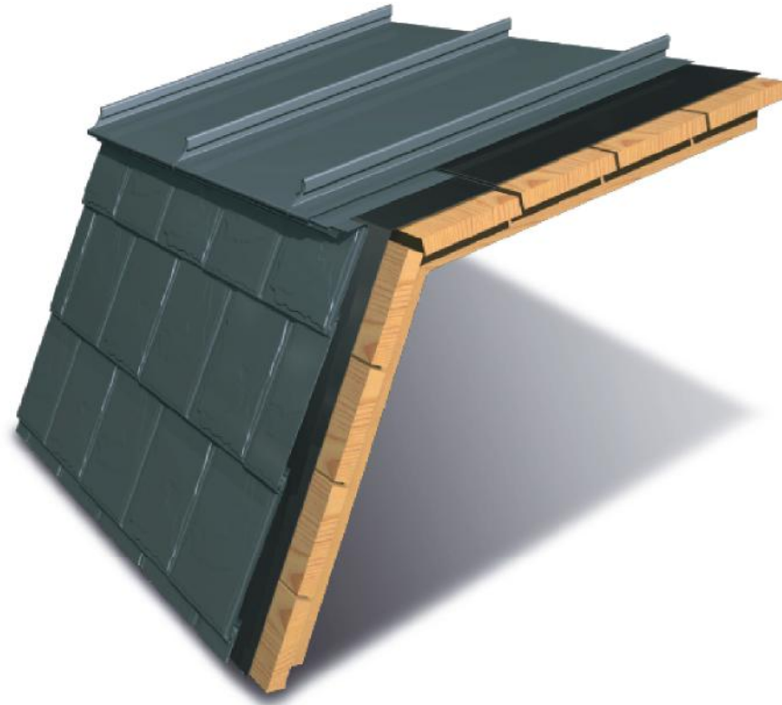
DETAIL DACHÜBERGANG IN STEHFALZEINDECKUNG
