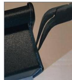
2 Um eine feste Verbindung zu erhalten, wird der Falz geschlossen. Zur Vorbeugung von Kratzern empfehlen wir die Falzzange mit einem Klebeband abzukleben.
