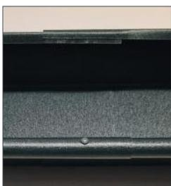
6 Hinteren Falz schließen und Zwinde entfernen.
